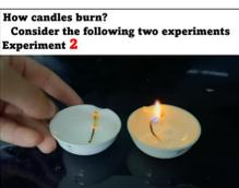
図6 左は綿糸を燃やしたようす。右は綿糸の近くに削ったロウがある。ロウがとけて綿糸に染み込むことで、綿糸の火は長く続いた。
